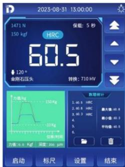
适用于淬火、调质、退火、冷硬铸件、硬质合金钢、铝合金、铜合金、轴承钢等硬度测定。也适用于表面淬火钢，材料表面热处理和化学处理层，铜、铝合金，热轧、冷轧薄板、镀锌、镀铬、镀锡材料等。
